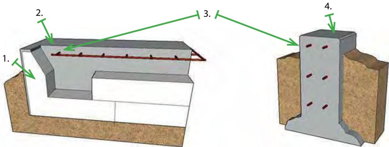
1. Wenn Kantelemente Teil der Konstruktion sind, ist es entscheidend, sie im Beton zu verankern, anstatt im expandierten Polystyrol-Komponenten.
