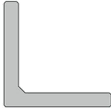
Kantelemente bieten Unterstützung und Isolierung während des Gießens eines Betonhausfundaments. In erster Linie bestehen Kantelemente aus expandiertem Polystyrol mit einer dünnen Faserzement-Schicht.
